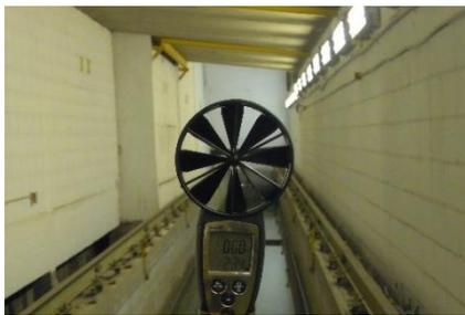
Las calibraciones de **anemómetros para velocidades de viento entre 0.1 y 2 m/s** se realizan en el Canal de Pruebas Navales y Pesqueras de la Facultad de Ingeniería. Este laboratorio consiste en un cuenco estanco (aire en reposo) de 70 m de largo, contando con un carro dinamométrico responsable por el movimiento de los instrumentos.
