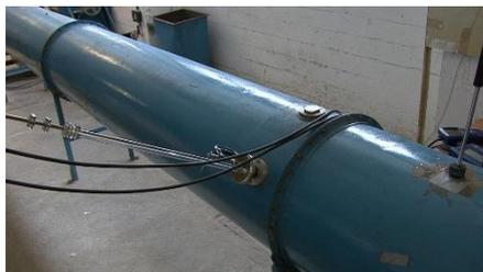
Para calibrar **caudalímetros de gases en rangos altos (entre 400 y 4000 m<sup>3</sup>/h)** se conecta el instrumento a la entrada de una tubería cilíndrica donde se tiene un flujo inducido por un ventilador axial. Se regula el caudal mediante variador de frecuencia que acciona el motor del ventilador. El caudal de referencia se mide con un tubo Pitot siguiendo la norma ISO 3966.
